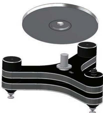
**Abb. 8:** Montage des Subtellers mit Skalenring
