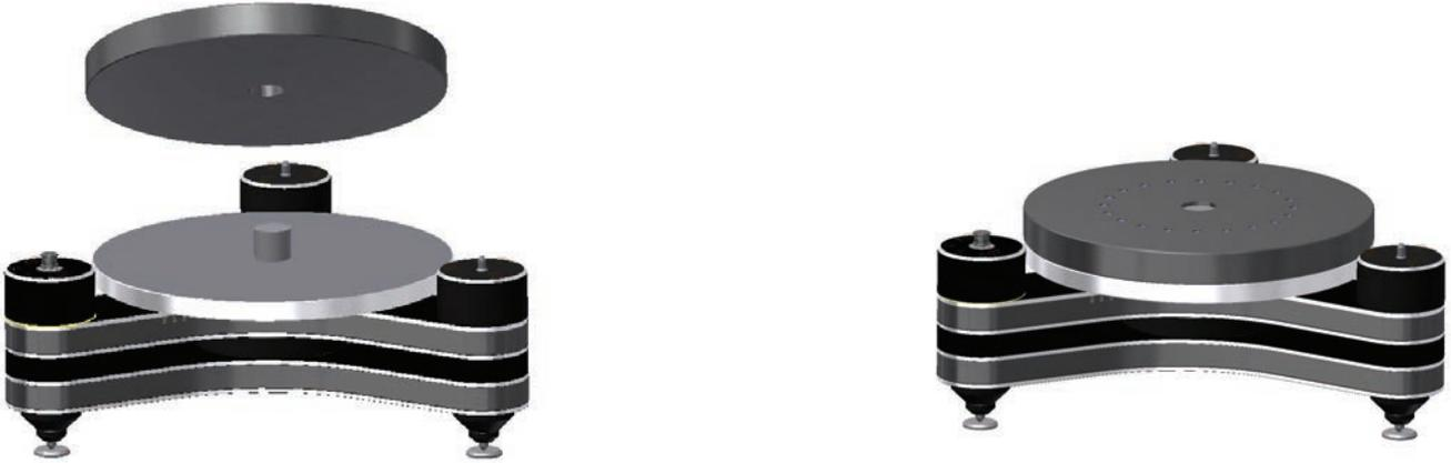
**Abb. 9:** Aufsetzen des Antriebstellers
