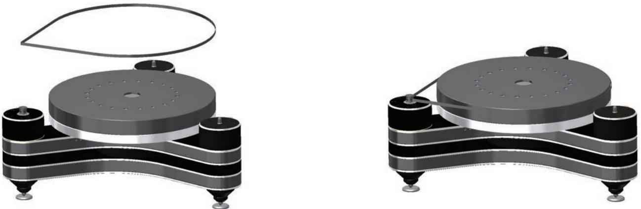
**Abb. 10:** Umlegen des Antriebsriemens
