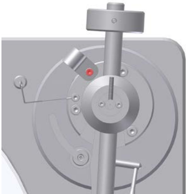
Bild 4: Befestigung der Kabelführung an der Tonarmbasis
