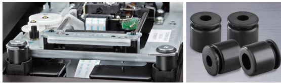
Auf Viskosedämpfern gelagerter Traverse-Mechanismus
